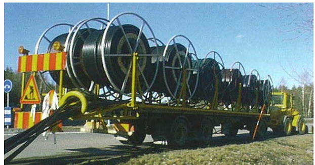
PAC-ABLE-csévélőgép: lehetővé teszi egyidejűleg több különböző jelzésű cső lefektetését egy árokba
